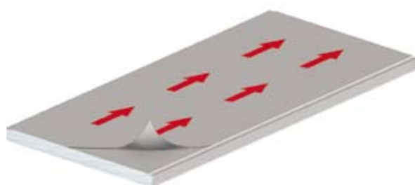
6.2. att. Aizsargplēves noņemšanas virziens
